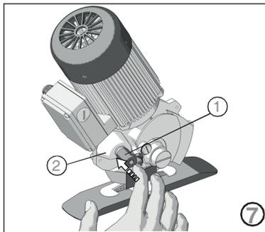
Wenn der Schleifvorgang nicht erfolgreich war, muss die Abnutzung der Schleifscheibe "3" (siehe Abb.8) überprüft werden. Wenn die Feder "3" zu stark abgenutzt oder verschmutzt ist, muss sie ausgetauscht werden.
